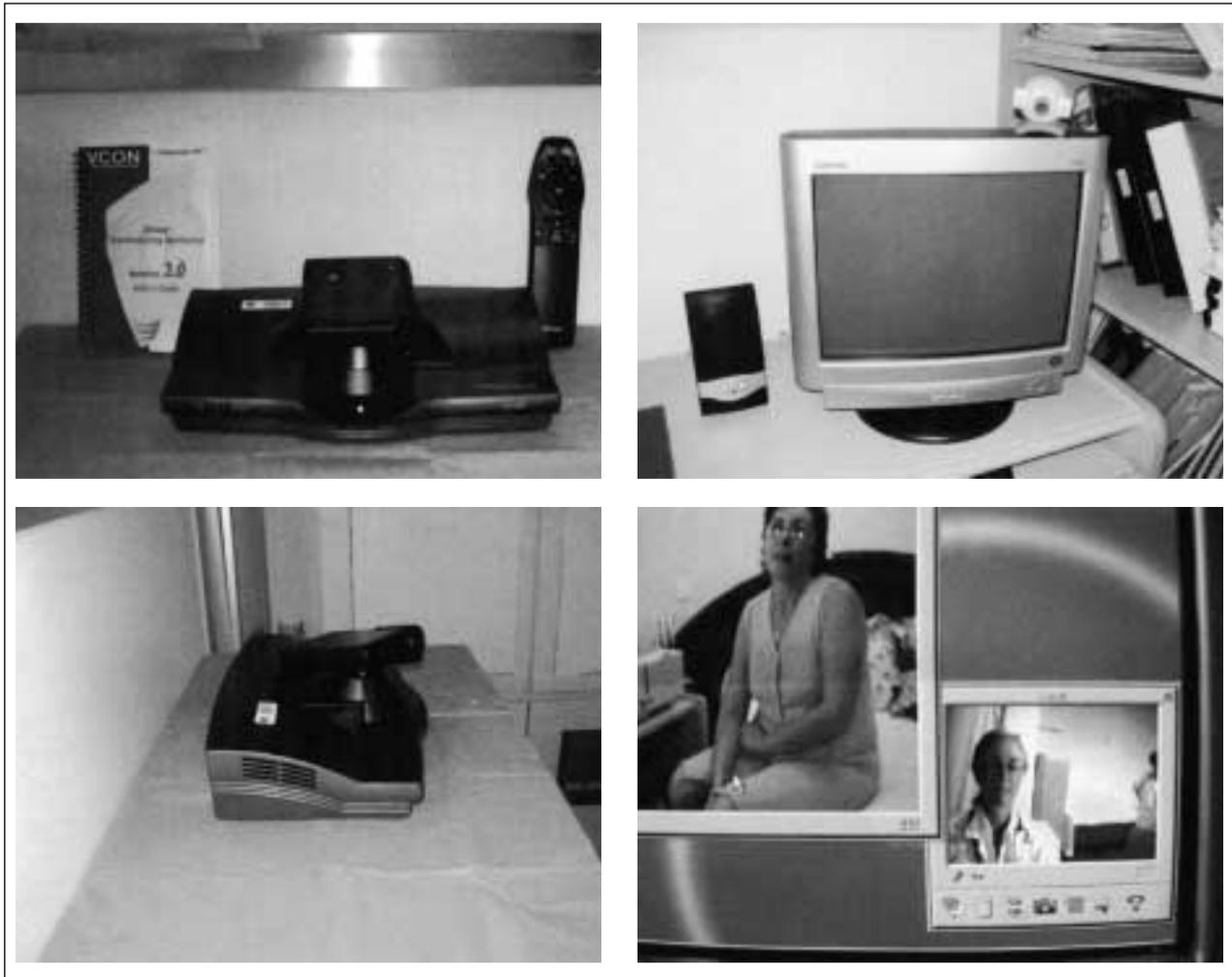
Fig. 1.—Equipo en el domicilio del paciente: equipo de videoconferencia con cámara con control remoto desde el hospital. Equipo en el hospital: ordenador, tarjeta de videoconferencia, webcam.
