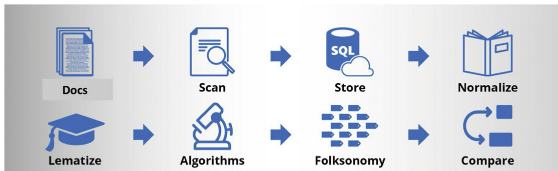
Figura 1 – La solución propuesta por Bismart se basa en un flujo de datos que comienza con la incorporación en la base de datos de conocimiento de los documentos PDF aportados por Hospital del Mar. Sobre estos documentos se aplican procesos de OCR y la definición de los campos que queremos importar de cada documento. Una vez almacenados en la base de datos e identificados los campos, el sistema inicia el proceso de folksonomía, detectando palabras o grupos de palabras importantes en el conjunto de documentos. Una vez que la herramienta Folksonomy ha extraído la información que se necesita para trabajar, ésta se presenta en una Web para que pueda ser consultada, modificada o para ejecutar de nuevo el proceso a petición.
